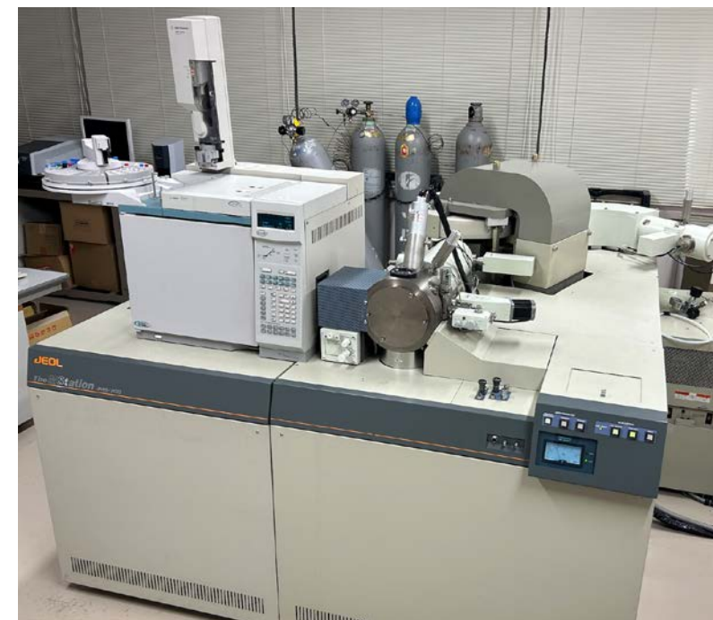
二重収束磁場型質量分析計（JEOL JMS-700）
