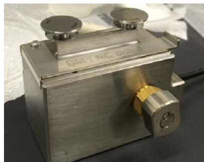
ポンプユニット プランジャーシール等の交換
