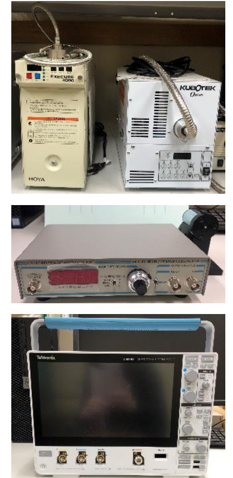
図2 オプション品(紫外線照射装置(上左)、可視光光源装置(上右)、オプティカルチョッパー(中)、オシロスコープ(下))
