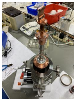
冷凍機が組み上がった様子
