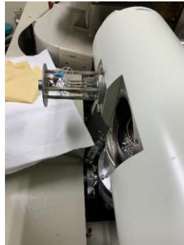
イオン導入部内の清掃作業
