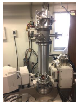
冷凍機が組み上がった様子
